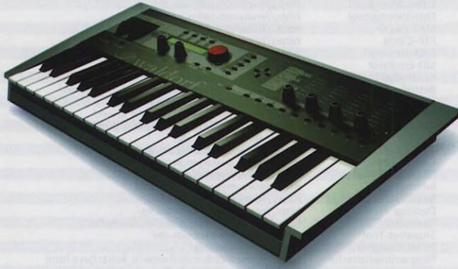
Ansonsten bietet das virtuell-analoge Schmuckstück die gleichen Merkmale wie sein Kollege aus dem Rack: Je nach Oszillatorenlastung bis zu 25-stimmige Polyphonie, 16-facher Multimode, zwei Multimode Filter, 6 Audio-Ausgänge, zwei Audio-Eingänge, Arpeggiator, Vocoder, Effektprozessor. Auch die Endlos-Drehregler und die für Waldorf Synthesizer typische rote Nase sind mit an Bord.
