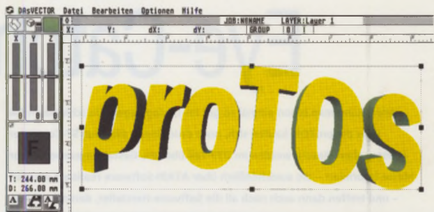
Bild 2: In einem ersten Schritt wird der Text der Kugelform angepaßt. Im Bild geschieht das über die Netztransformation in DA's Vektor.
