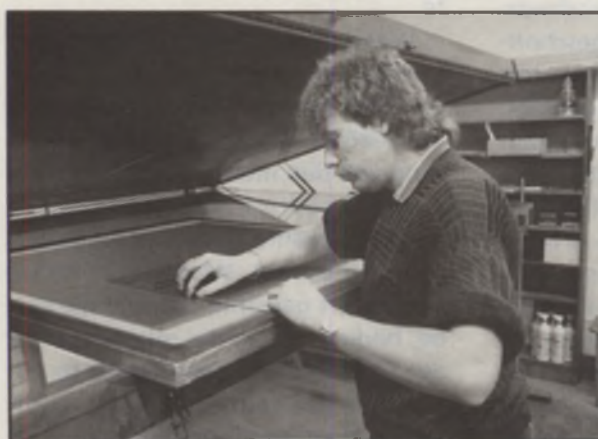
Siebdruck: Da auf einem Sieb oft gleich mehrere Filme belichtet werden, z.B. für die verschiedenen Farben einer Drucksache, muß der Stand der Filme sehr präzise kontrolliert werden.
