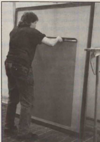
Siebdruck: Vor dem Druckvorgang wird das Sieb mit einem lichtempfindlichen Mittel beschichtet.
