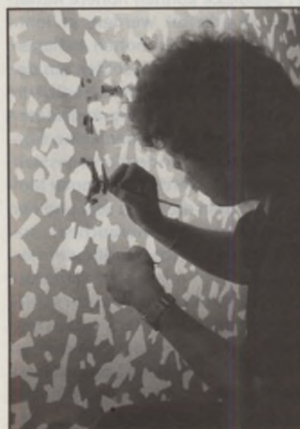
Siebdruck: Ohne Handarbeit geht es auch im Siebdruck nicht. Nach der Belichtung des Siebes müssen Belichtungsfehler von Hand korrigiert werden.
