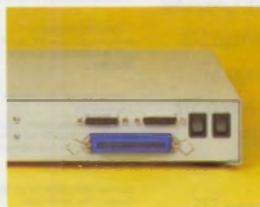
SCSI Schnittstelle an Geräterückseite herausgeführt
