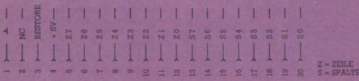
Belegung des Tastatursteckers beim VC-20
