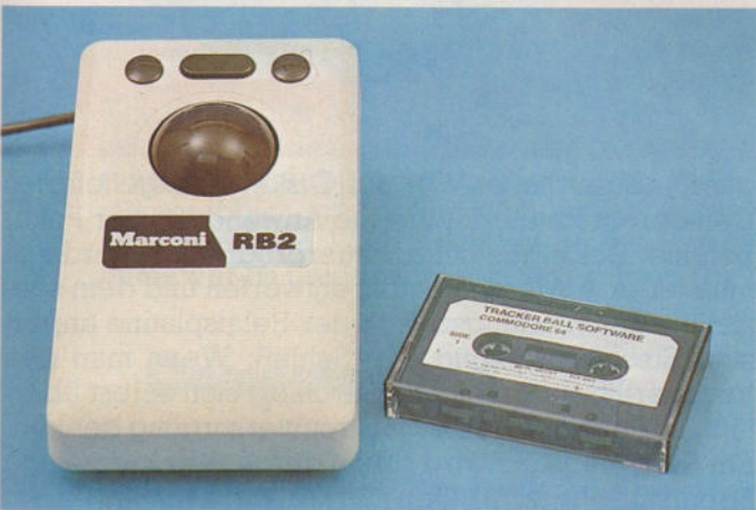
Der Trackball ist eine „Maus“ die auf dem Rücken liegt.
