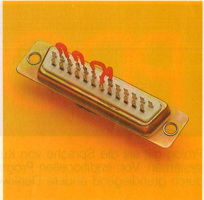
Selbstgespräche: Nach dieser einfachen Lötarbeit können DFÜ- und Hackprogramme getestet werden, ohne daß Telefongebühren anfallen
