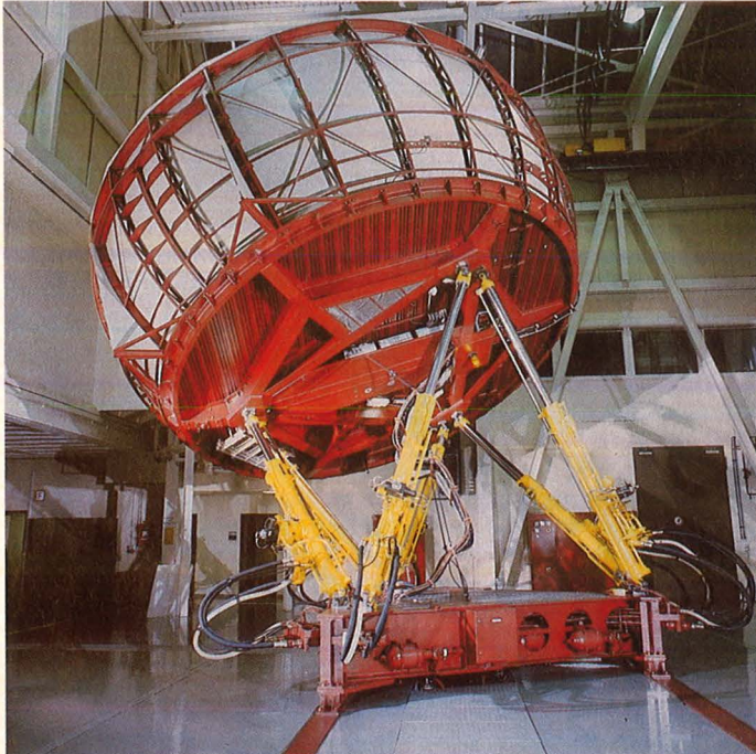
Sechs Freiheitsgrade: Ein aufwendiges Hydraulik-System sorgt für wirklichkeitsnahe Bewegungs-Simulation
