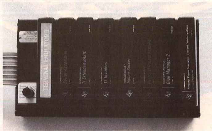
Der richtige Dreh genügt, und schon ist beim Modul-Expander eine andere Cartridge zugeschaltet
