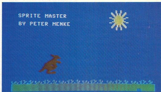
Dieser Befehl schaltet Sprites ein. Es stehen acht Sprites zur Verfügung, die von 0–7 nummeriert sind. Die Sprite-Daten können aus 128 verschiedenen Bereichen geholt werden, das heißt, man kann maximal 128 Sprites gleichzeitig definieren. Die Bereiche sind von 0–127 nummeriert.
