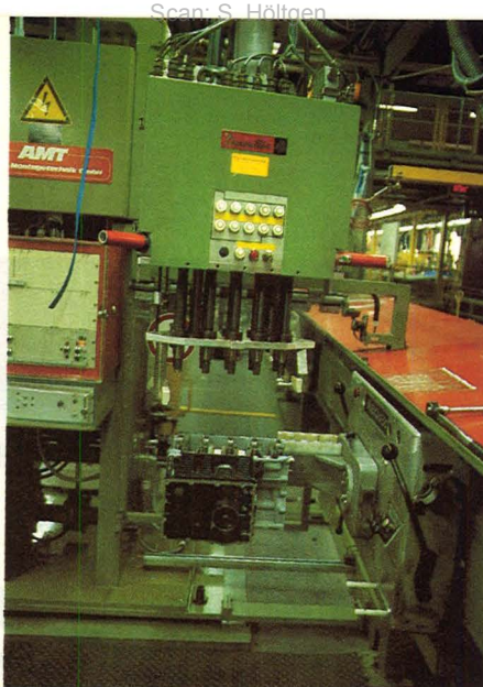
Lockere Schrauben verpönt: Der CNC-Automat arbeitet mit genau definiertem Drehmoment
