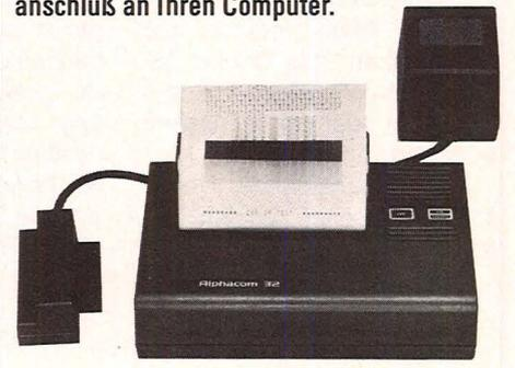
Und das bietet der Alphacom 32: Durch einfachen Steckeranschluß sofort betriebsbereit. Eingebautes Interface für den Sinclair ZX81 und ZX Spectrum, mit allen Befehlen voll Sinclair-kompatibel. 32 Zeichen pro Zeile. Ausdruck aller Grafikzeichen. Hochauflösende Grafik. Sehr klarer Ausdruck auf Thermopapier. Druckt 2 Zeilen pro Sekunde.
