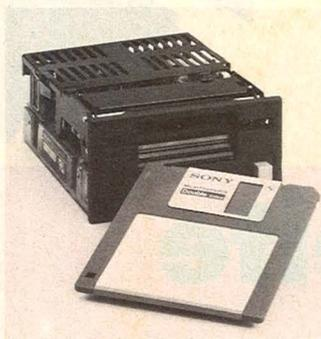
Beschädigung geschützt. Durch einen exakten Positionierungsmechanismus in Verbindung mit einem neu entwickelten Schreib-/Lesekopf ist eine Speicherkapazität bis zum einem Megabyte möglich.
