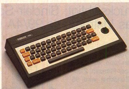
definierbare Sonderzeichen zuordnen. Bei der Programmierung von Spielen eröffnet diese Eigenschaft also ungeahnte Möglichkeiten. An Peripherie-Ausgängen finden sich die Steckplätze für TV (Pal oder NTSC), externen Lautsprecher, Disketten- und Kassettenstation, Drucker und eine 44-Pin-Steckleiste für zusätzliche ROM-Packs.
