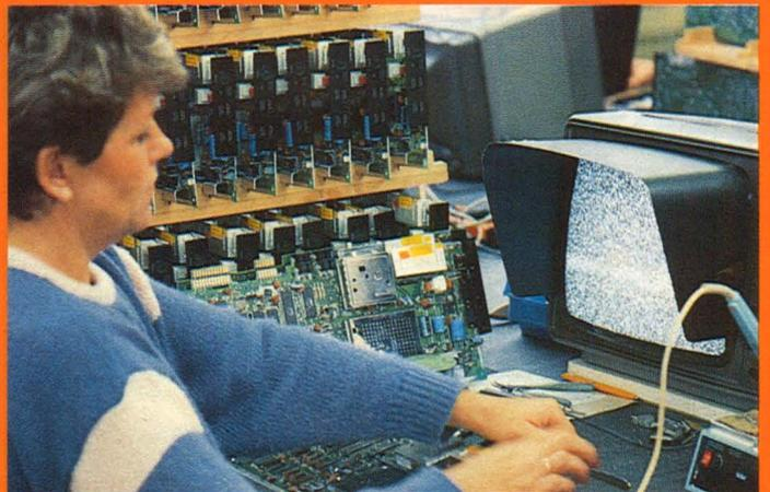
*Jede einzelne Platine wird sorgfältig durchgecheckt. Defekte Exemplare wandern sofort zur Nachbesserung*
