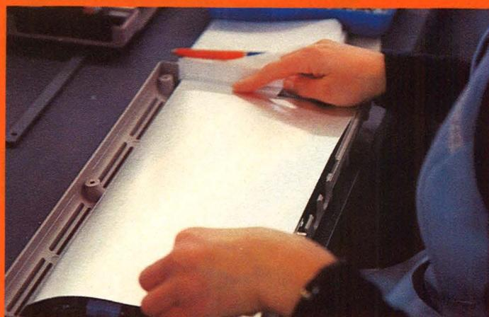
Großflächige Störschutzfolien sollen dem Nachbarn ungetrübten Fernsehgenuß ermöglichen
