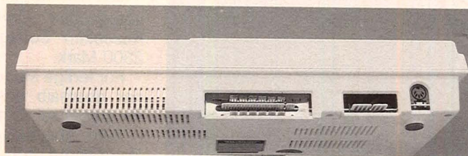
Anschlüsse für Expansionsbox, Recorder und Monitor
