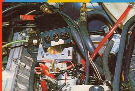
Die Zentraleinheit im Motorraum: Zuständig für das Kabel-Bus-System
