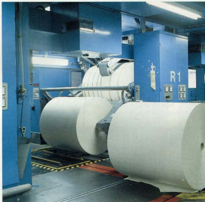
Der Drucktechniker muß jede einzelne dieser mächtigen, tonnenschweren Rollen Papier sorgfältig einspannen. Über ein Schienen- und Weichensystem fädelt sich das Papier dann schließlich vollautomatisch in das Druckwerk ein.
