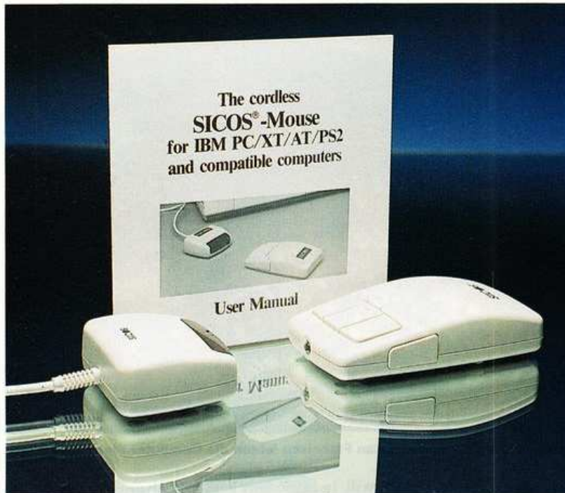
Wie eine TV-Fernbedienung überträgt die Sicos-Maus Befehle in Infrarotlicht
