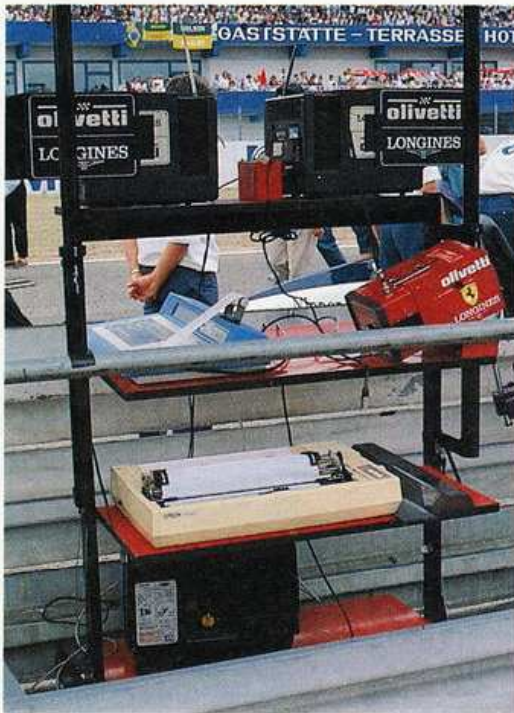
Der Österreicher Gerhard Berger (Foto ganz links) fährt einen Ferrari, dessen Motordaten von abhörsicherer Laserstrahlen in den Computer der Boxenmannschaft übertragen werden. Eine kleine Computeranlage (Foto links) hält ständig Kontakt mit allen Ferrari-Motoren. Beim Boxenstopp — wie hier bei Honda-Pilot Ayrton Senna (Foto rechts) — können die Techniker den Fahrer instruieren. Auch die Rennleitung (Foto oben) stoppt die Zeiten inzwischen elektronisch.
