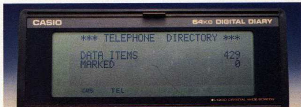
Der Casio zeigt auf seiner rechteckigen Anzeige 32 Zeichen in sechs Spalten gleichzeitig
