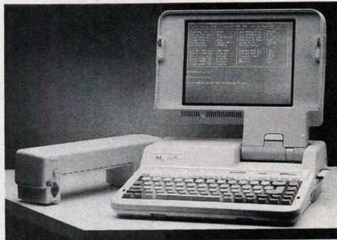
Wenn das Akku-Pack (links) an die Rückseite geschraubt ist, kann der Laptop netzunabhängig arbeiten
