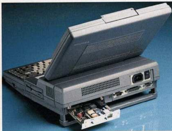
Das neue Einschubmodem für alle Toshiba-Laptops wird in den internen Steckplatz eingebaut
