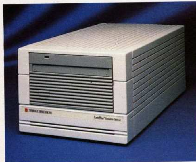
Im klobigen Kasten schreiben feine Laserstrahlen bis zu 1 GByte Daten auf eine optische Platte
