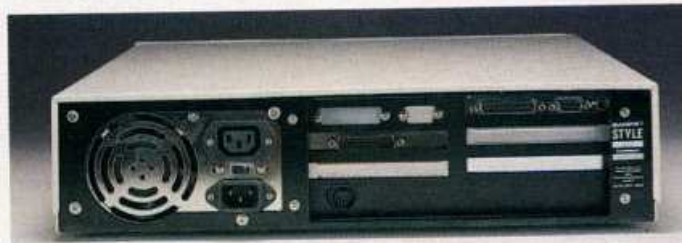
Unpraktisch: Weil fast alle Steckplätze des Quadral bereits belegt sind, kann man den AT kaum erweitern
