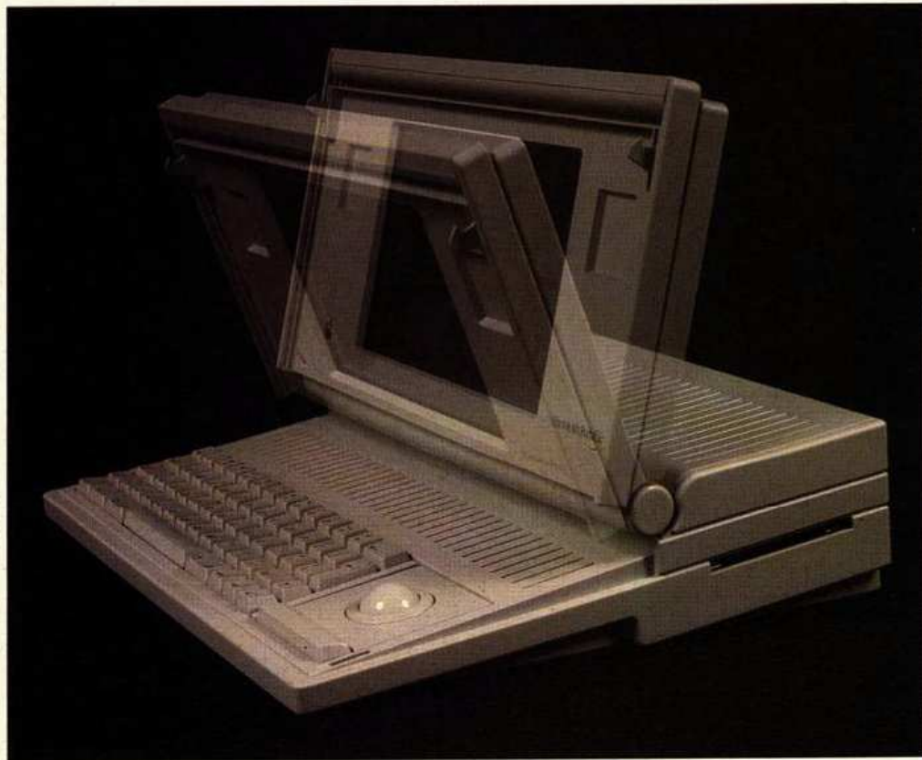
Klappe hoch — Mac bereit: Das flache LC-Display wird zum Transport über die Tastatur gelegt. Rechts unten: Das eingebaute 3½-Zoll-Laufwerk.
