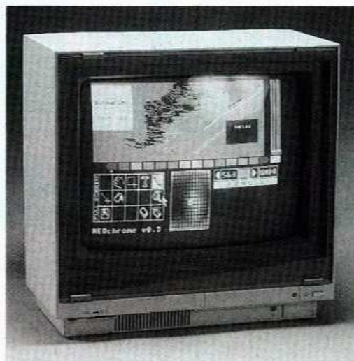
Auch Monitore haben nur eine begrenzte Lebensdauer. Achten Sie auf die Schärfe des Bildes und eventuell Einbrennschäden auf dem Schirm.
