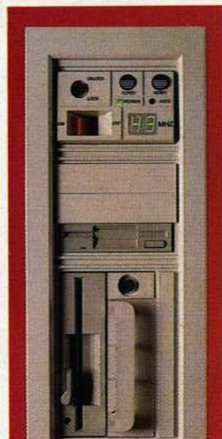
Speicher en masse: Wechselplatte, Festplatte und zwei Diskettenlaufwerke
