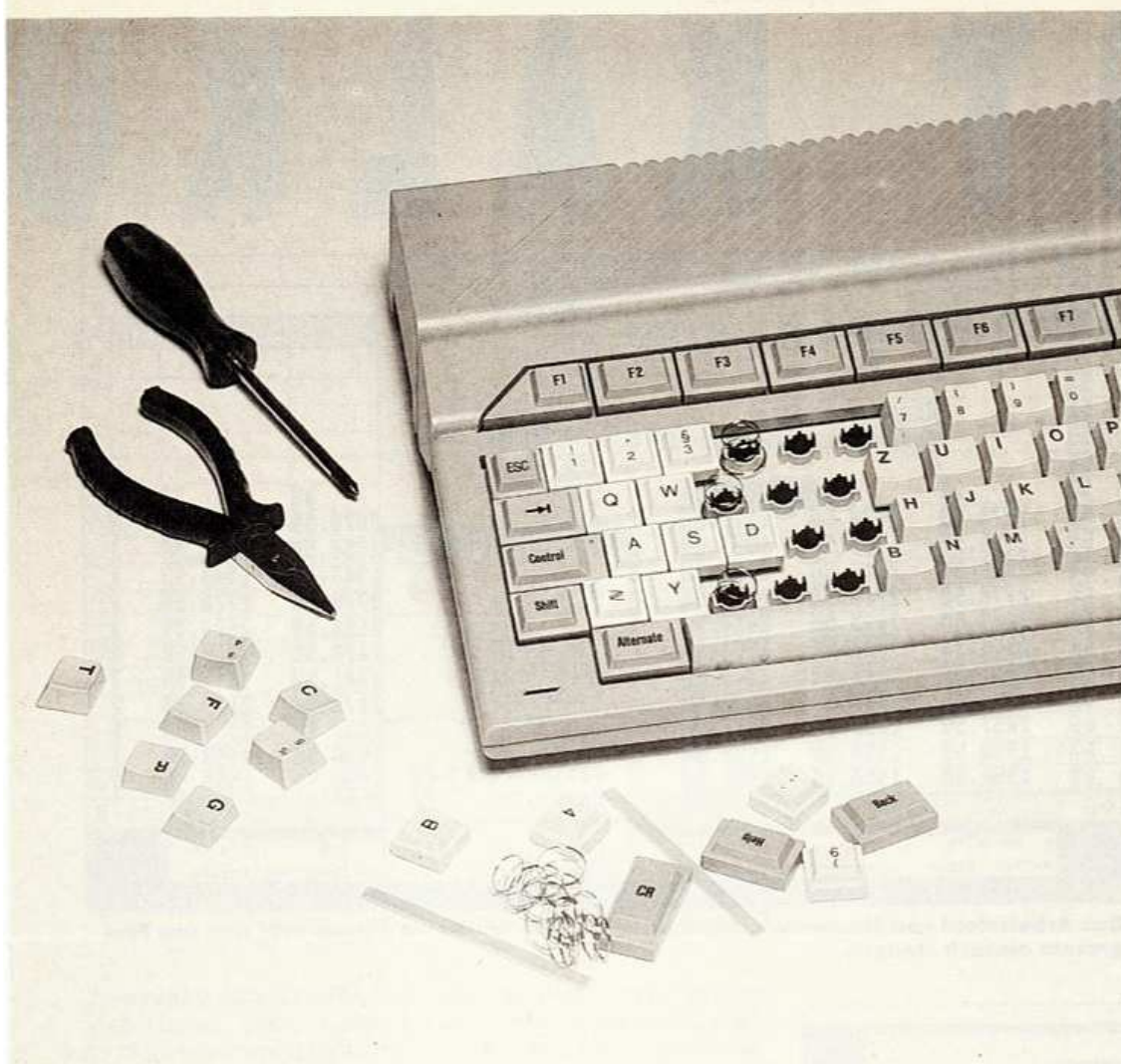
Mit Zange, Schraubendreher und Geduld verhelfen Sie dem ST zur neuen Tastatur
