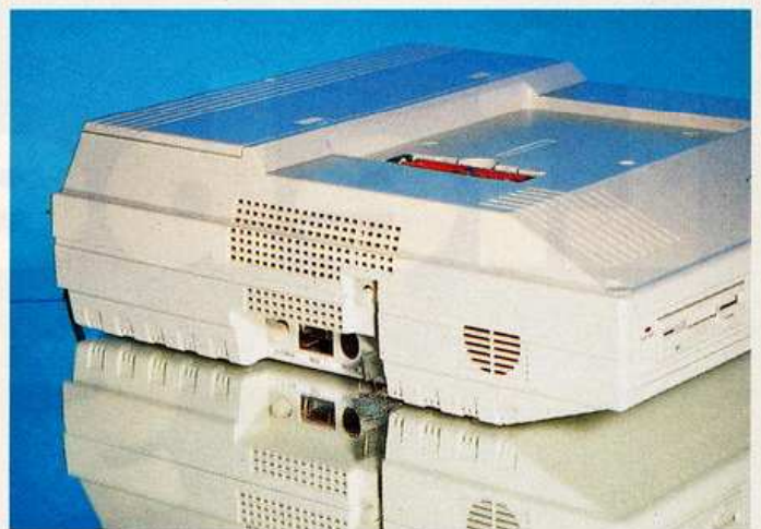
Im Gehäuse des Amstrad-ATs befinden sich die Batterien und eine Aussparung für den Monitor 24.5.VO
