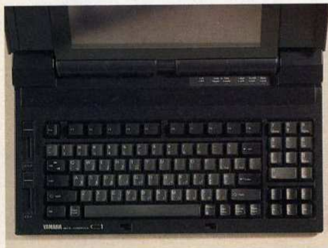
Links neben der Tastatur mit Notensymbolen befinden sich zwei MIDI-Schieberegler
