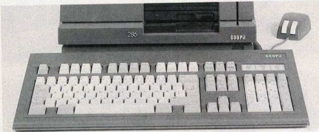
Die Multifunktions-Tastatur besitzt 102 statt nur 82 Tasten, wie eine PC-Tastatur
