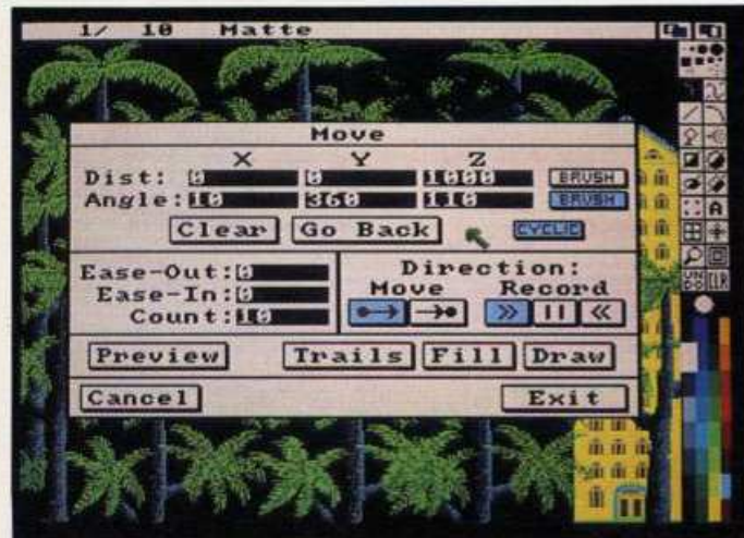
Wenige Angaben im Move-Menü genügen, um Sequenzen mit bewegten Objekten berechnen zu lassen
