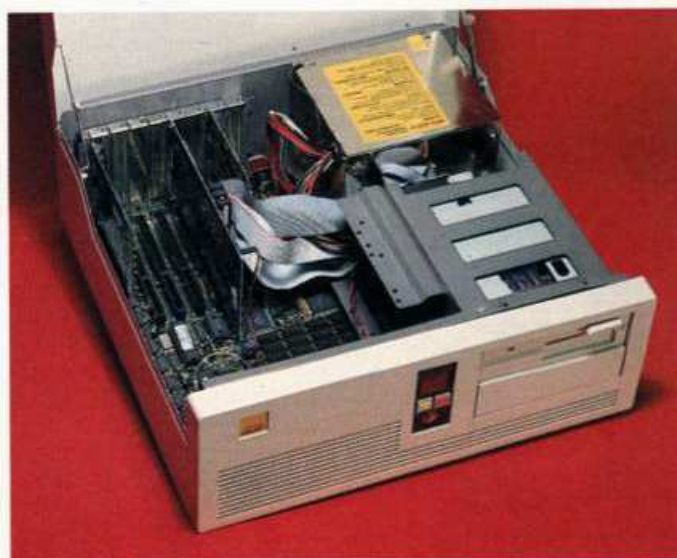
Praktisch ist ein Gehäuse, das sich wie hier beim Anra-AT, aufklappen läßt
