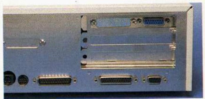
Die Rückseite des Peacock: Links der Mausanschluß, rechts die Abdeckungen der waagrecht liegenden Steckplätze.
