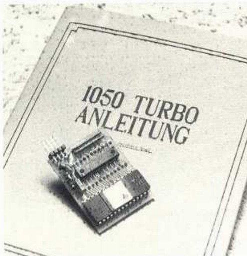
Klein aber fein: die Turbo-1050-Platine mit eingebautem Backup-Programm
