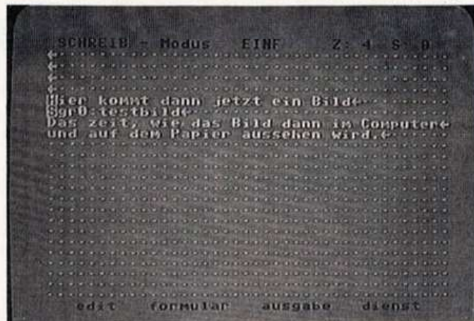
Textomat Plus: Die Grafik wird ausgedruckt, aber nicht auf dem Bildschirm dargestellt
