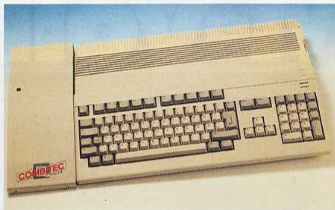
Bild 1. Unser Testmodell Combitec D-RAM 2M war mit 2 MByte ausgestattet. Combitec rüstet auf Wunsch die Erweiterung auf 4 oder 8 MByte auf.
