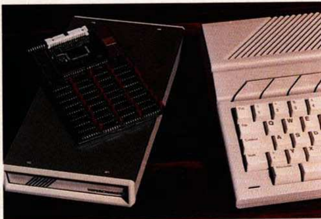
Erstausnahulich klein: Der Supercharger findet in einem Modem-Gehäuse Platz. Er besitzt dieselbe Grundfläche, wie die Atari-Floppy und läßt sich platzsparend auf deren Gehäuse stellen.
