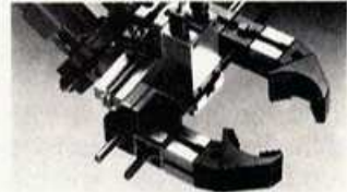
Greifhand mit symmetrischem Spindeltrieb.
