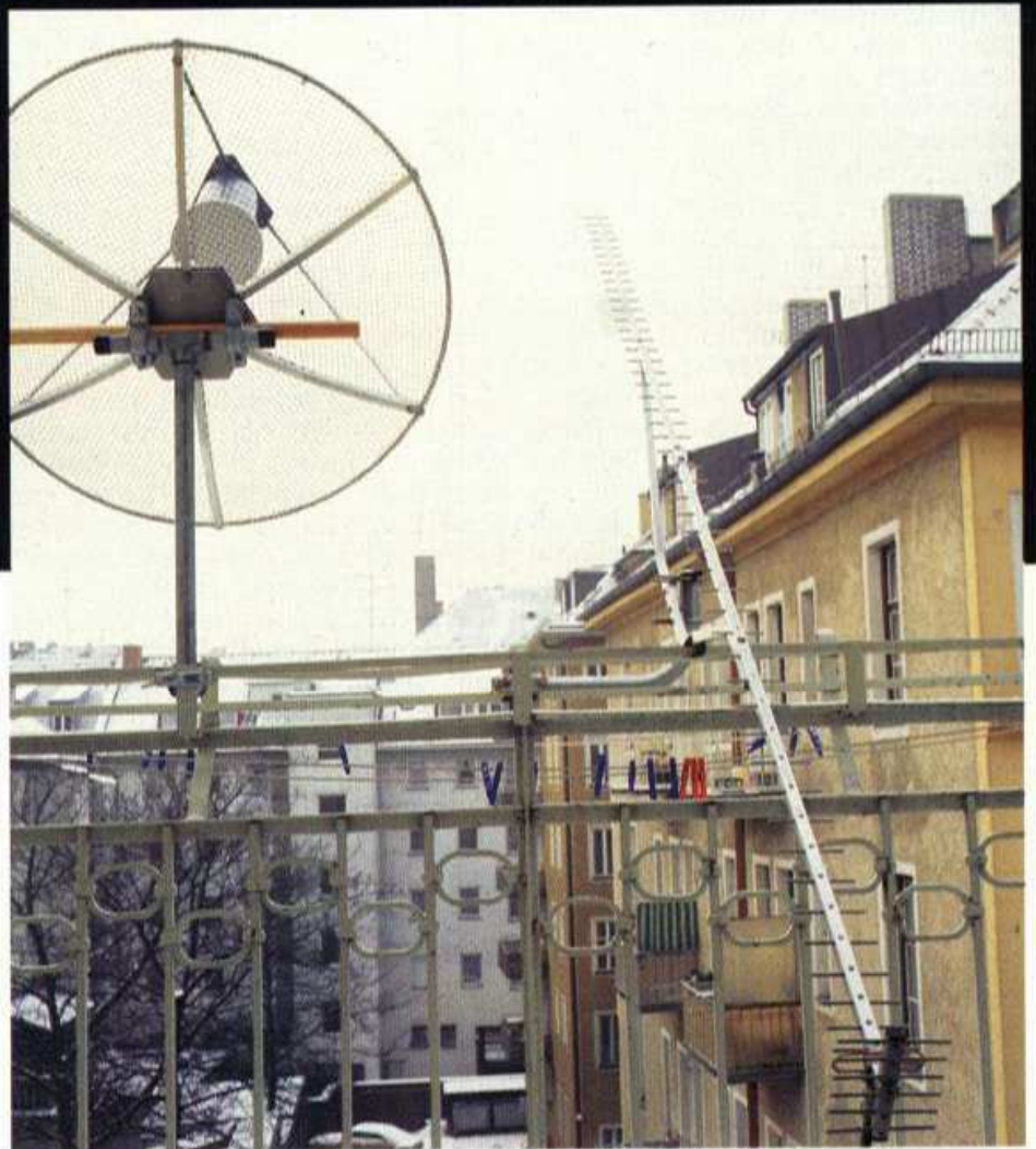
Zum Empfang von »Meteosat«-Bildern ist eine Parabol- oder Yagiantenne gut geeignet
