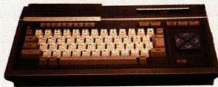
Auch er besitzt 64 KByte RAM und MSX-Eigenschaften: SPC-800 von Samsung
