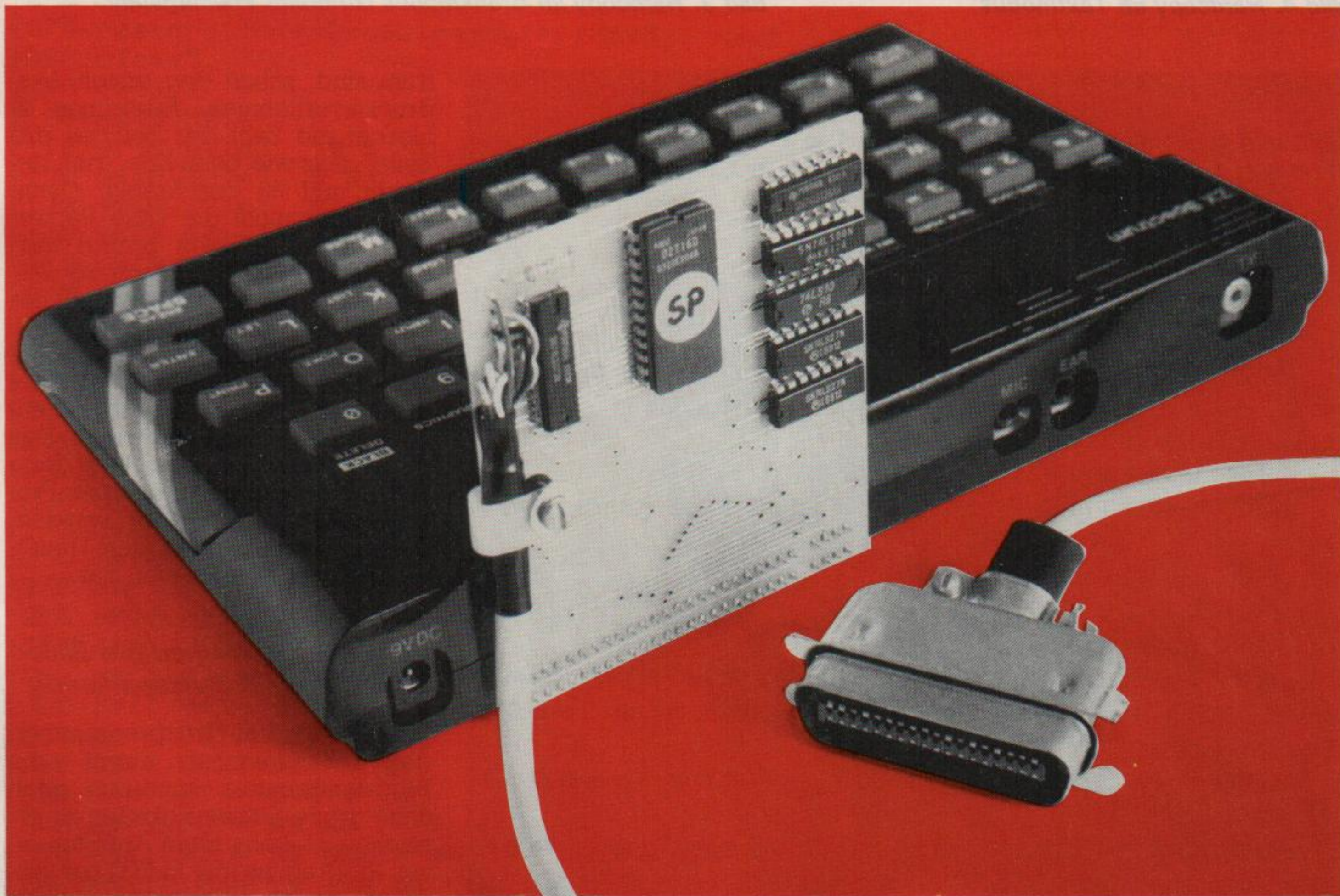
Mit dieser Interfacekarte kann der Spectrum an einem Epson-Matrixdrucker betrieben werden
