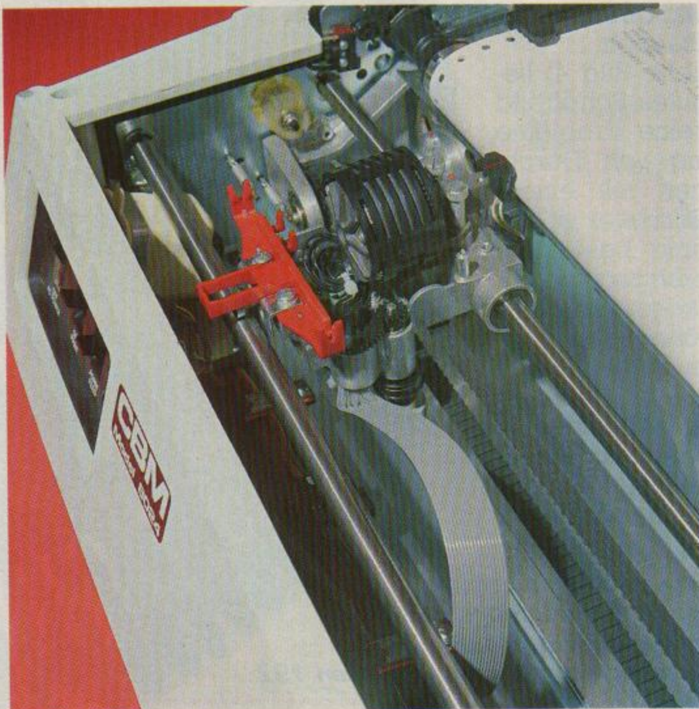
Bild 6. Der Matrixdruckkopf wird auf der Transportschiene mittels des Transportbandes hin und her bewegt
