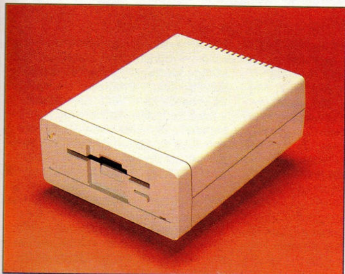
Diskettenstationen sind die wichtigsten Peripheriegeräte für die Atari ST-Computer, da nur im »1040 ST« schon ein Laufwerk eingebaut ist
