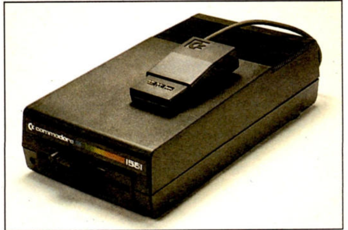
Bild 2. Schneller Massenspeicher: VC 1551
