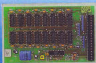
Speichererweiterung A 501. Heavy tuning mit clockset! Erweitert RAM um 512 KB auf 1 MB.
