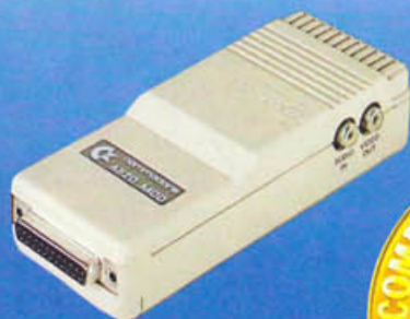
A 520 Video-Adapter Für alle, die TV oder Videomonitor an den A 500 anschließen wollen.
