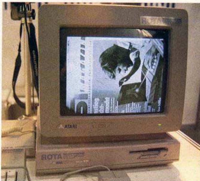
Bild 2. Der Videodigitalisierer SAM beeindruckt durch hohe Wiedergabequalität und Echtzeit-Digitalisierung
