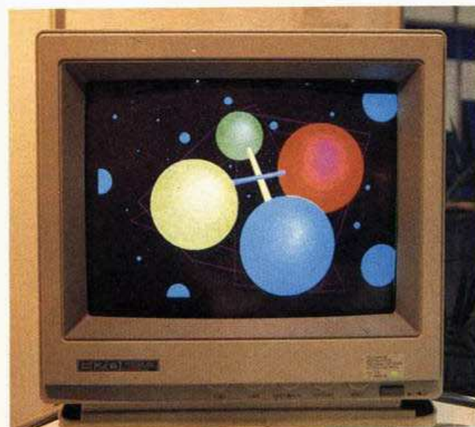
Bild 1. 820 x 512 Bildpunkte in 256 satten Farben bietet die «ColorCAD»-Grafikerweiterung von Omega
