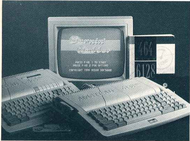
Durch futuristisches Kurvendesign schlugen die neuen CPCs voll aus der Art. Trotzdem wurde auf Altbewährtes Wert gelegt: Floppy oder Tape sind im Tastaturgehäuse untergebracht.
