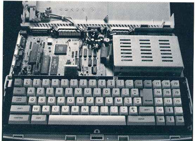
Entgegen der Hardware in den alten CPCs wirkt die Floppy im Innenraum eines CPC 6128 (plus) im Vergleich zur Platine regelrecht monströs.
