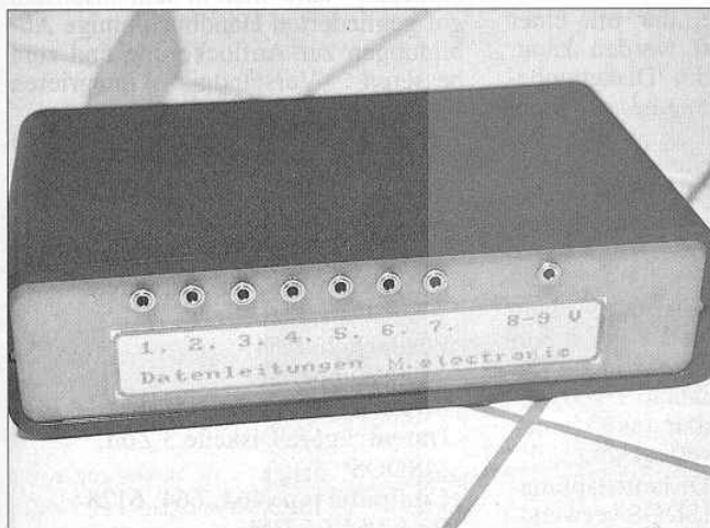
Das Schalt-Interface ist mit 7 Bit parallel geschaltet.
