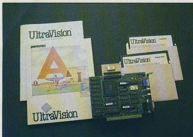
Abb. 1: Dieses unscheinbare Platinchen bildet die gelieferte Hardware, die aus einem PC 1512 mit EGA-Karte einen VGA-Computer macht. Zusammen mit der dazugehörigen Software...
