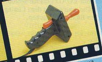
Phasor One Ein Joystick mit Pistolengriff, Microschaltern und extra langem Anschlusskabel!
