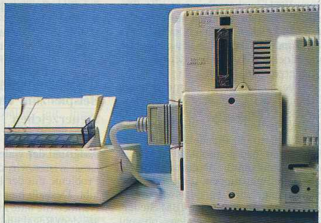
Abb. 2: Auch die PCW-Rechner können neben ihrem eigenen Drucker einen Fremdrunder mit Centronics-Anschluß betreiben, wenn sie selbst über die Centronics-Schnittstelle verfügen.
