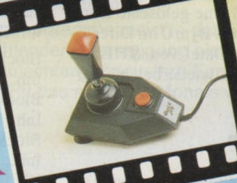
Quickjoy I Joystick mit Microschaltern, einschaltbarem Dauerfeuer und Saugnäpfen.
