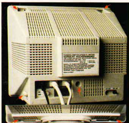
Bild 1: Vier Schrauben sind zu lösen. Reglerknöpfe nicht vergessen! (siehe Pfeile)
