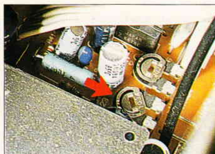
Bild 2: Das V-Size-Poti (Pfeil) wird beim Monochrom-Monitor auf anderseitigen Anschlag verdreht
