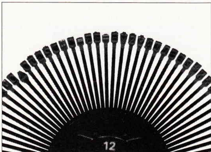
Bild 1: Das Typenrad: langsam und unflexibel, aber gestochen scharf...
