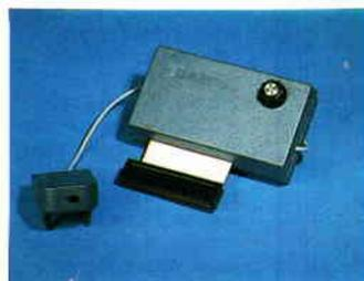
Mit Hilfe des Dart Scanners sind Besitzer des Druckers DMP 2000 (bzw. Riteman F+) in der Lage, ihren Printer zum Scanner umzurüsten. Das System besteht aus einem Interface, das auf den Expansion-Port der CPC's aufgesteckt wird und einem Scan-Kopf, der einfach auf den Druckkopf aufgeschoben wird.
