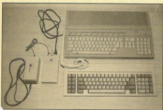
Die steckfertige Lösung: AT.A ST verbindet AT-Tastatur und Atari ST
