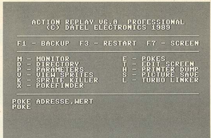
[4] Im POKE-Menü der Action-Replay werden nach dem gezeigten Schema die POKES eingegeben
