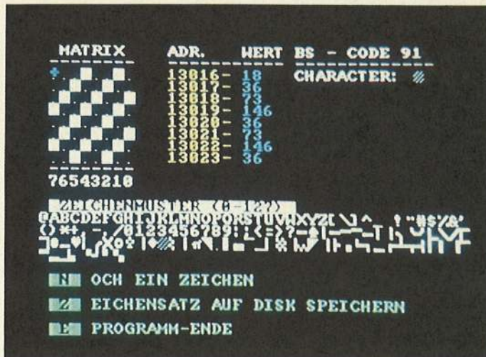
[2] Muster für NEWPAINT werden nach demselben Prinzip wie Zeichensatz-Matrizen entwickelt
