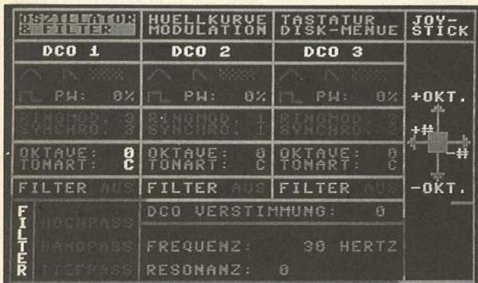
[3] Frequenz, Wellenform und die Parameter der Filter lassen sich in diesem Menü komfortabel einstellen
