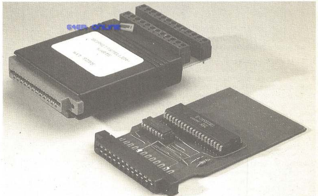
[1] Einfach und billig zu bauen: die Port-Erweiterung mit nur zwei ICs
