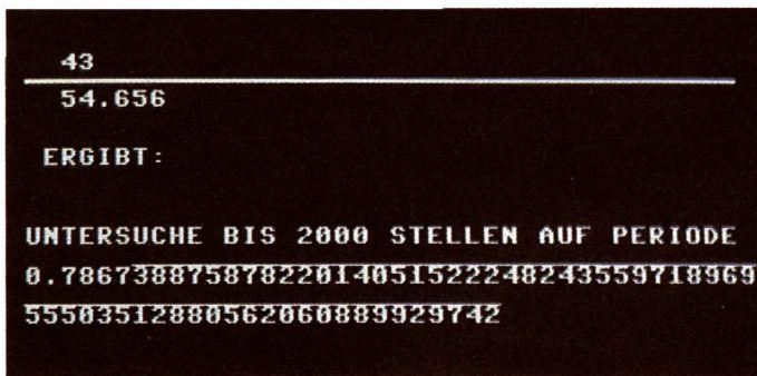
Bild 1. Exakt geteilt: ein Bruch mit 64 Stellen nach dem Komma. Am überstrichenen Zahlenteil läßt sich deutlich der periodische Bruch erkennen.
