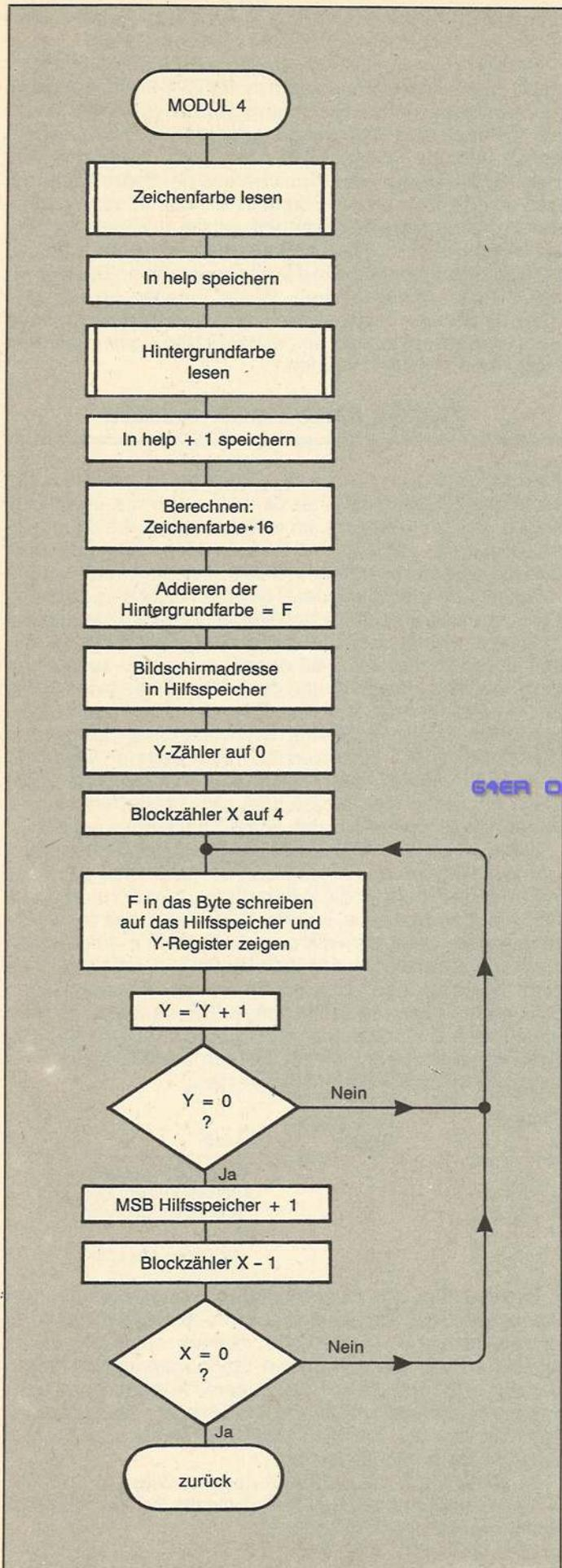
Bild 18. Flußdiagramm zum »Modul 4« – Farbgebung
