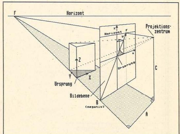
**Bild 1.** Die Bedeutung des Projektionszentrums bei der Zentralprojektion wird durch die Skizze verdeutlicht
