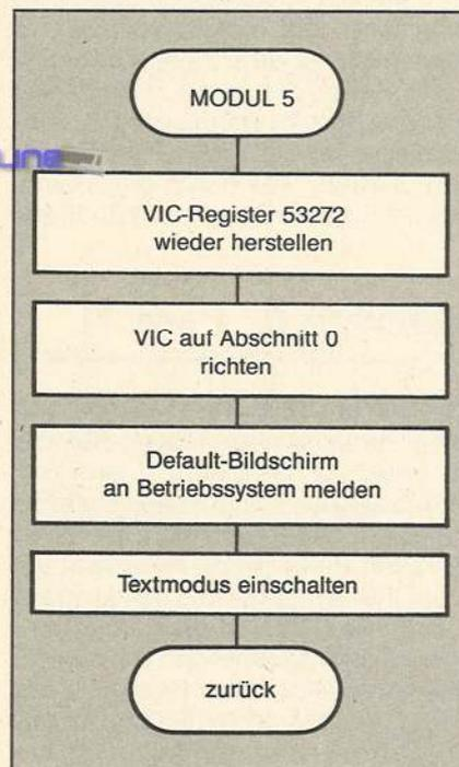
Bild 19. Flußdiagramm zum »Modul 5« – vom Grafikmodus in den Textmodus schalten
