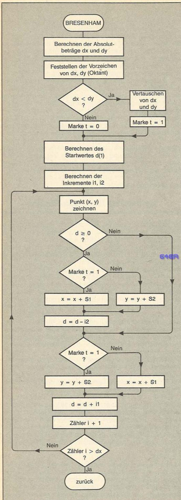
Bild 22. Flußdiagramm zum kompletten Bresenham-Linien-Algorithmus
