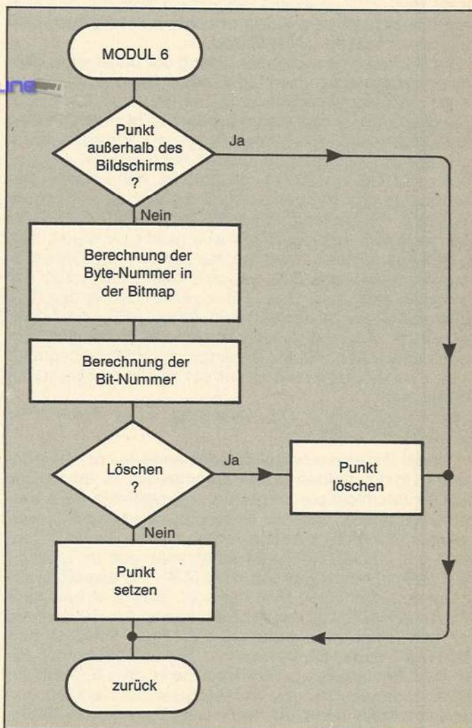
Bild 20. Flußdiagramm zum »Modul 6« - Setzen und Löschen von Punkten
