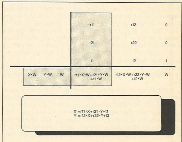
**Bild 67. Jede Transformationsmatrix kann im Endeffekt zu zwei Transformationsgleichungen reduziert werden**
