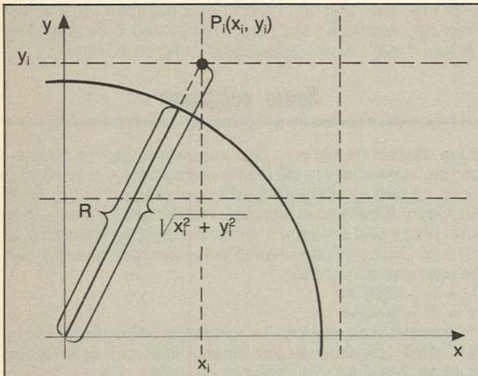
Bild 24. Der radiale Fehler beim Zeichnen eines Kreises
