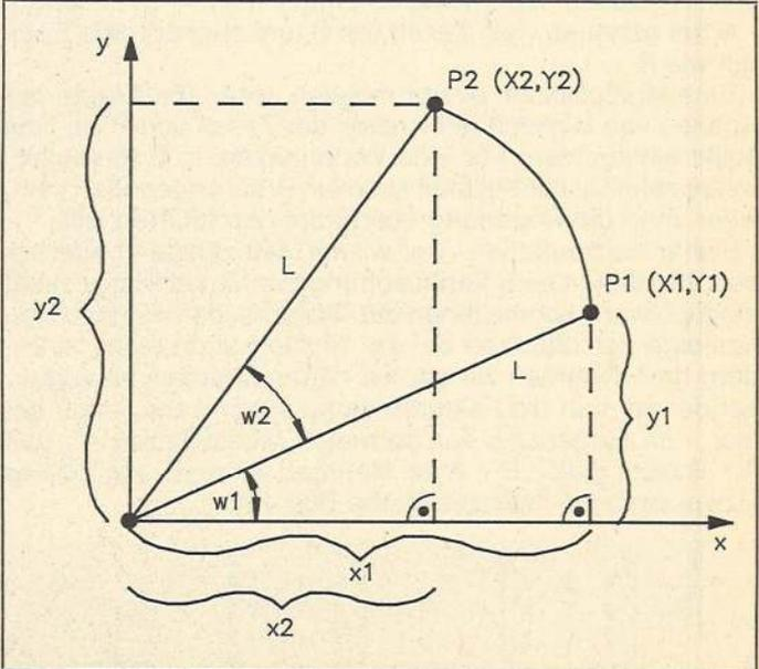
**Bild 51. Rotieren eines Punktes P1 um den Winkel W2**
