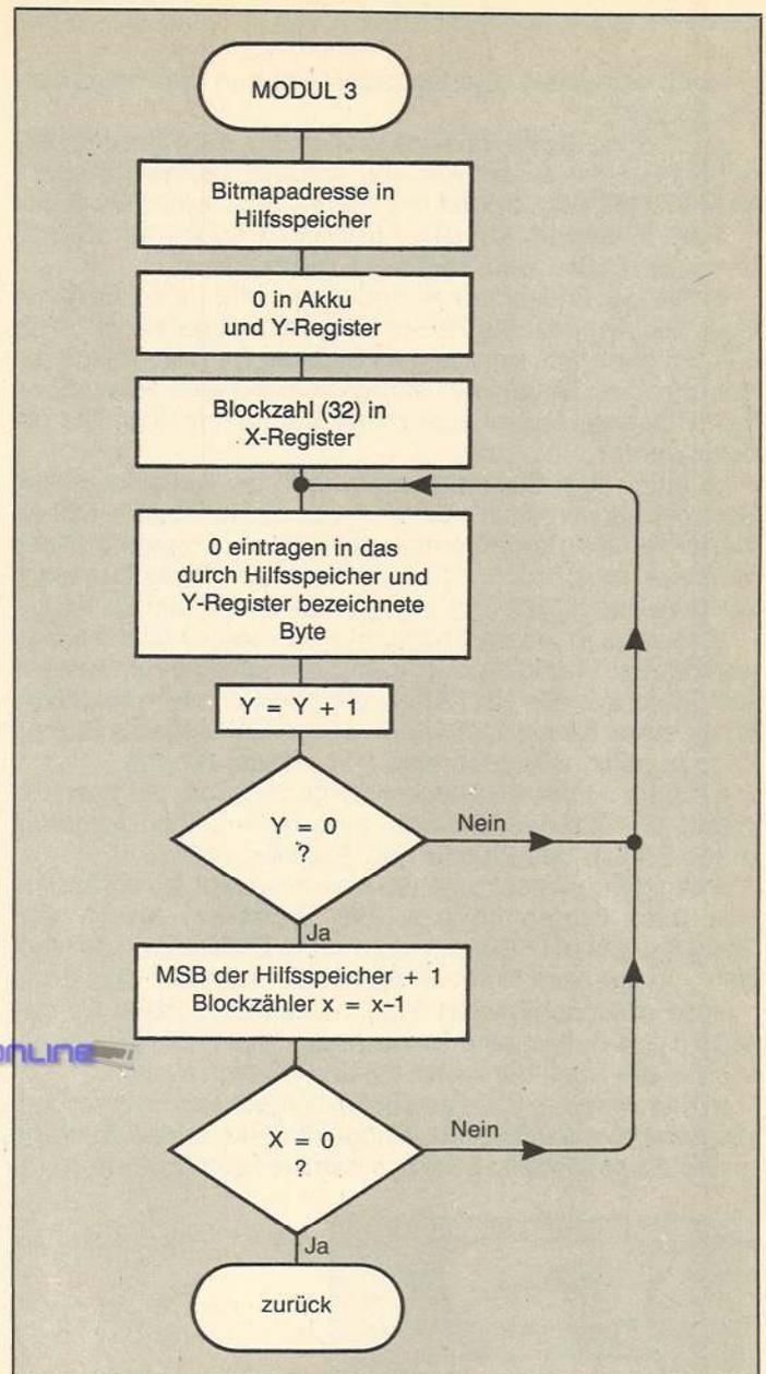
Bild 17. Flußdiagramm zum »Modul 3« – Bitmap löschen
