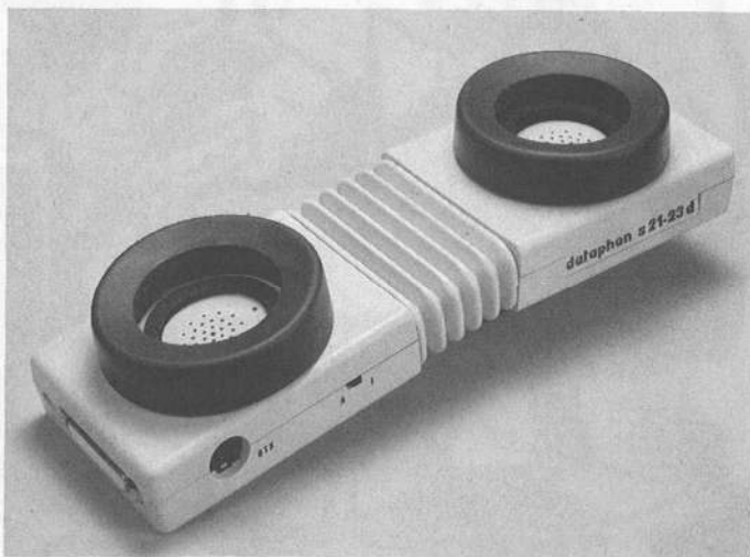
Bild 3. 1200/75-bps-Koppler mit seitlicher Anschlußbuchse für Btx-Decoder: Dataphon s21/23d (ab 350 Mark)
