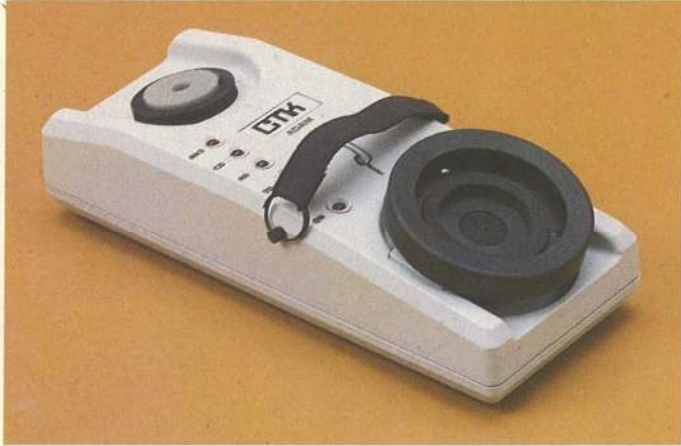
Bild 1. Der Akustikkoppler ist eine der Brücken zur DFÜ-Welt
