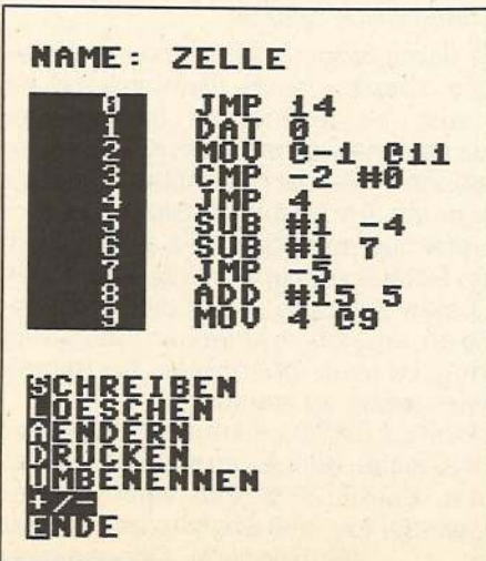
Bild 2. Der Editor zum Erstellen und Verändern eigener »Kämpfer«. Hier sind die ersten zehn Zeilen des Programms »Zelle« dargestellt.
