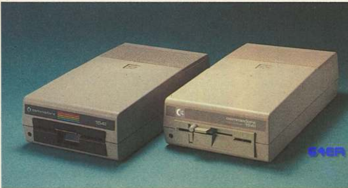
Bild 1. Äußerlich kaum zu unterscheiden: die Floppy 1541 (links) und die 1541c (rechts). Während viele (nicht alle) ältere Modelle noch mit Klappverschluss versehen sind, besitzt die 1541c ein Mitsumi-Laufwerk mit Knebelverschluss.
