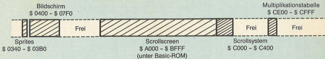
Bild 9. Speicherbelegung des Scrollsystems. Das Hauptprogramm liegt bei $C000
